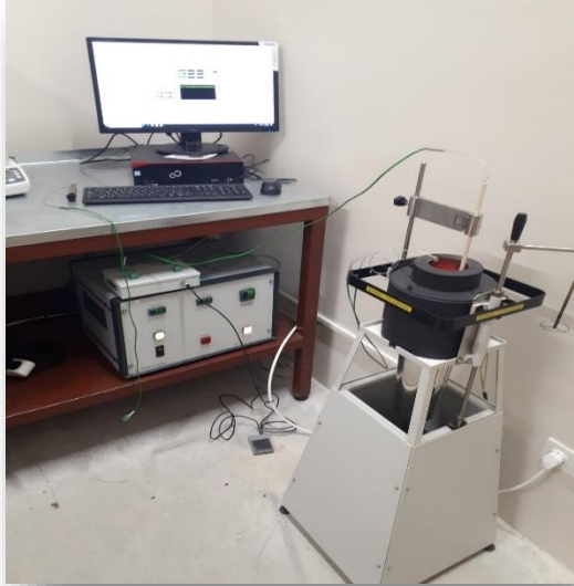
Yanmazlık Fırını ( TS EN ISO 1182 )
