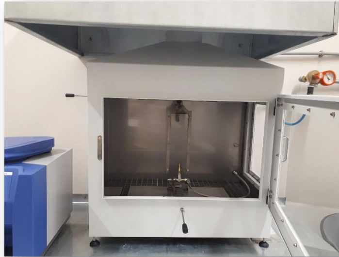
The Single-Flame Source Test ( EN ISO 11925-2 )
