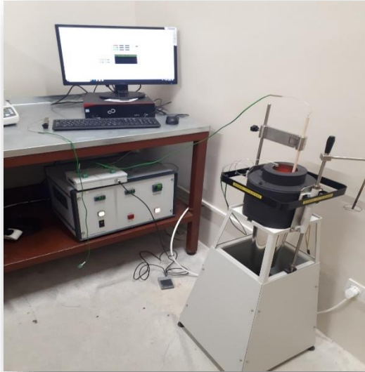
Non-Combustibility Apparatus ( EN ISO 1182 )
